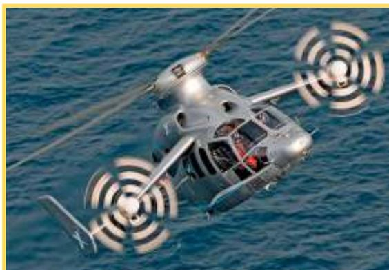
Outre la portée symbolique du record de vitesse - 472 Km/h (255 nœuds) lors d'un vol en palier effectué le 7 juin 2013 - les évaluations en vol du X3 ont permis à Airbus hélicoptères d'explorer de façon plus approfondie le comportement des rotors principaux à des vitesses élevées, ainsi que d'évaluer l'efficacité de l'optimisation de la traînée.
