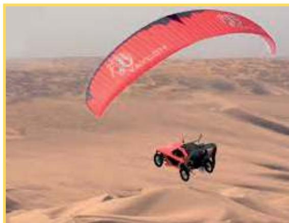
Pégase se déplace à 100 km/h sur route. Vitesse air : 60-80 km/h. Distance de décollage : 50-100 m. Atterrissage : 10-30 m. Altitude : vols à très basse altitude jusqu'à + de 3 000 m.
